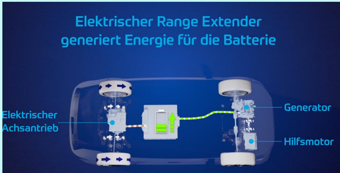
Schema eines Range Extenders
